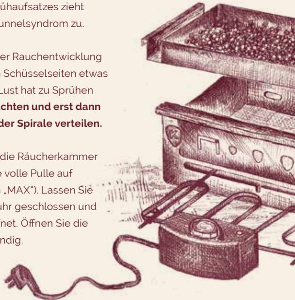
**Achten Sie bei eingestellter Position „MAX“ ganz besonders darauf, dass die Holzspäne nicht aufflammen und die empfohlene Höchsttemperatur von 150°C nicht überschritten wird. Daher empfehle ich, die Spirale nach dem Einschalten nicht länger als 5 Minuten auf „MAX“ zu betreiben.**
